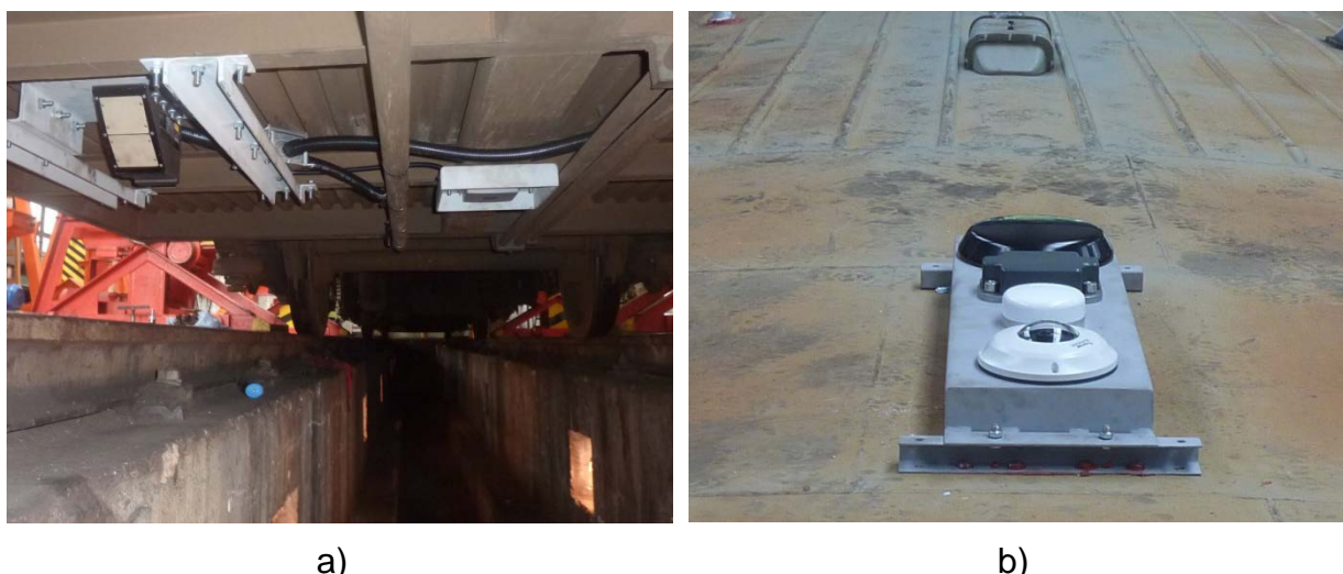
Obrázek 6: a) dopplerovský radar (vlevo) a anténa čtečky RFID (uprostřed) pod vozidlem 914.114, b) nástavec s GNSS anténami, širokopásmovou anténou a panoramatickou kamerou na střeše vozidla 914.114
