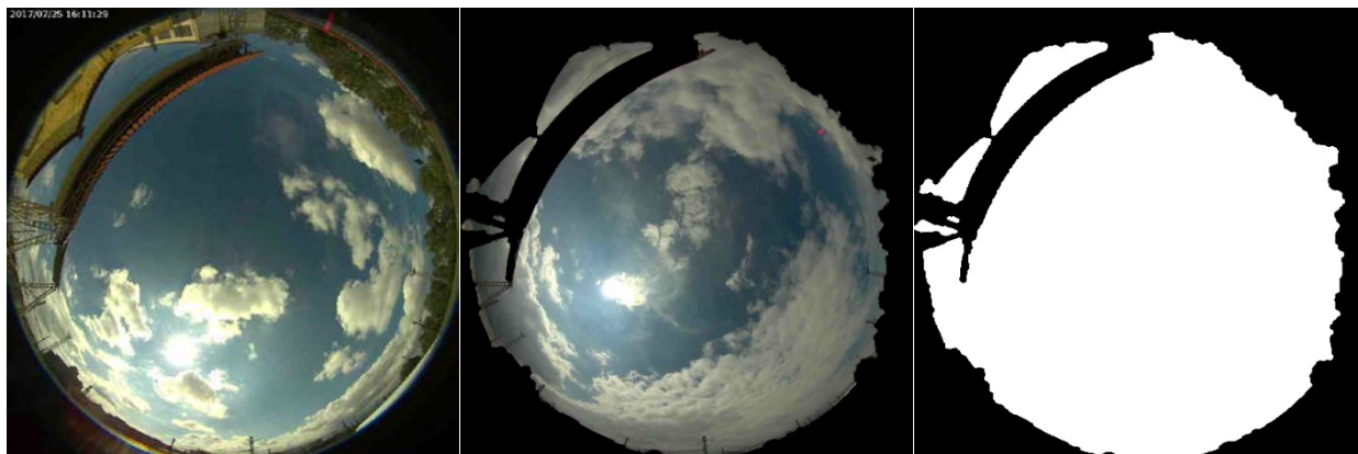
Obrázek 7: Postup zpracování panoramatických snímků; určení oblasti (azimutu a elevací), kde je signál GNSS zastíněn nebo kompletně blokován
