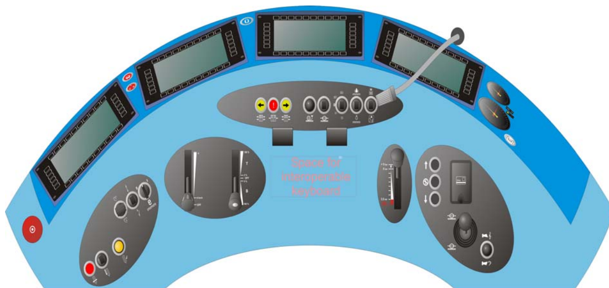
Obr. č. 1 Jednotný pult strojvedoucího
