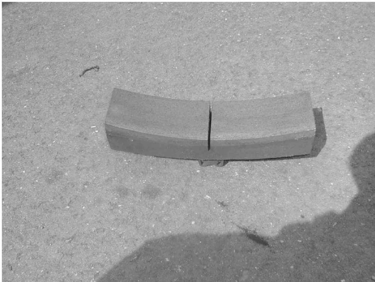
Obr. 7 Nekovový brzdový špalík typu „L“ Ferodo 3325
