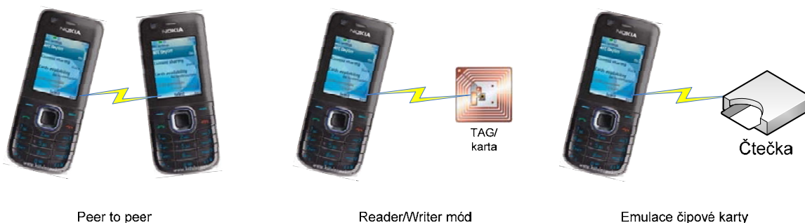
Obrázek 2 - Módy komunikace mobilního telefonu s NFC rozhraním
