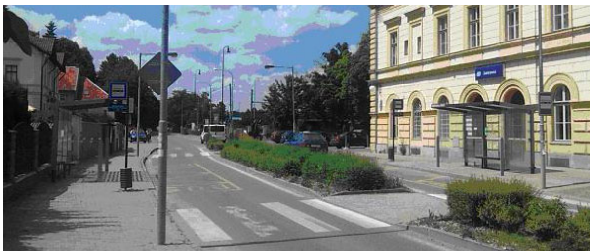
Obr. č. 6 - Zastávky navazující autobusové dopravy u železniční stanice Dobřichovice. Zátkovací zastávka působí zároveň jako zklidňovací prvek silniční dopravy, přístup do nádražní budovy ze zastávek autobusu je velmi krátký.
