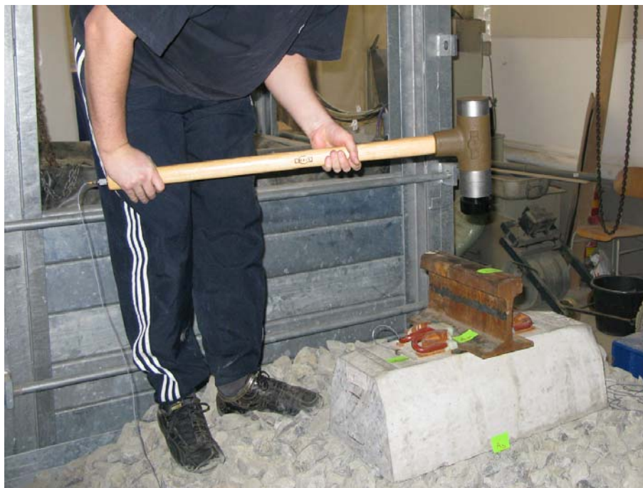
Obr. 4 Uspořádání zkoušky buzení rázem
