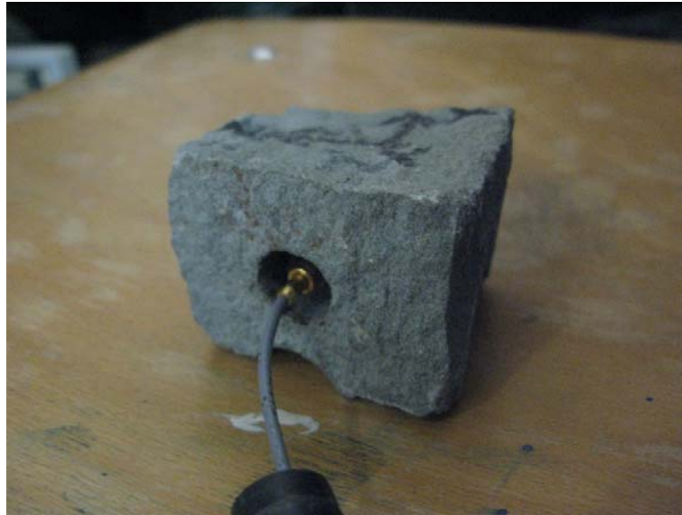
Obr. 3 Měřicí kámen se snímačem As
