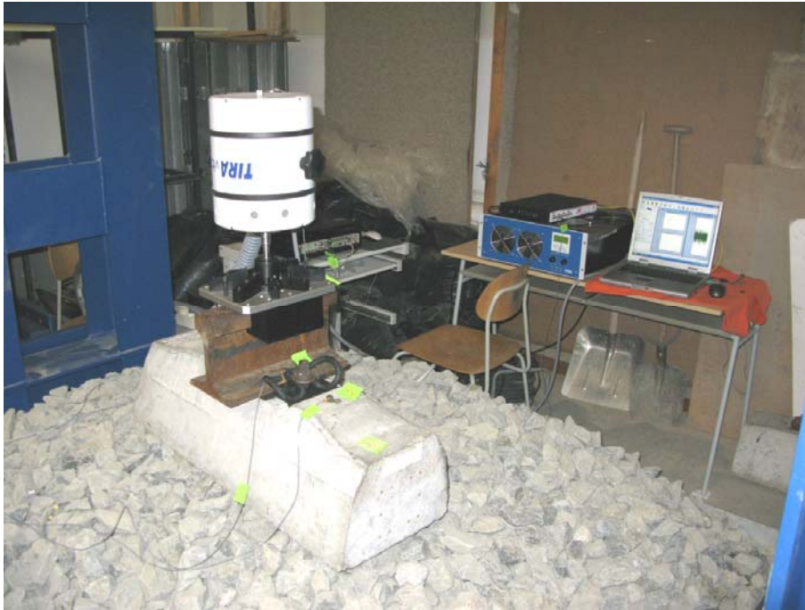
Obr. 5 Uspořádání zkoušky buzení vibrátorem
