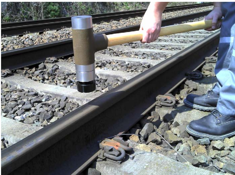
Obr. 6 Uspořádání ověřovací zkoušky in situ
