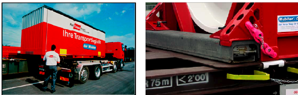
Obr. 9 - Překládka a příčné pásy na železničním voze [8]
