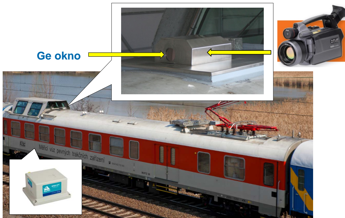
Obr. 4.1: umístění termovizní kamery na MVPTZ
