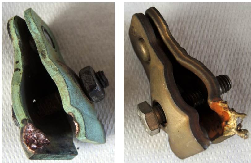
Obr. 8.2: teplem poškozená svorka věšáku
