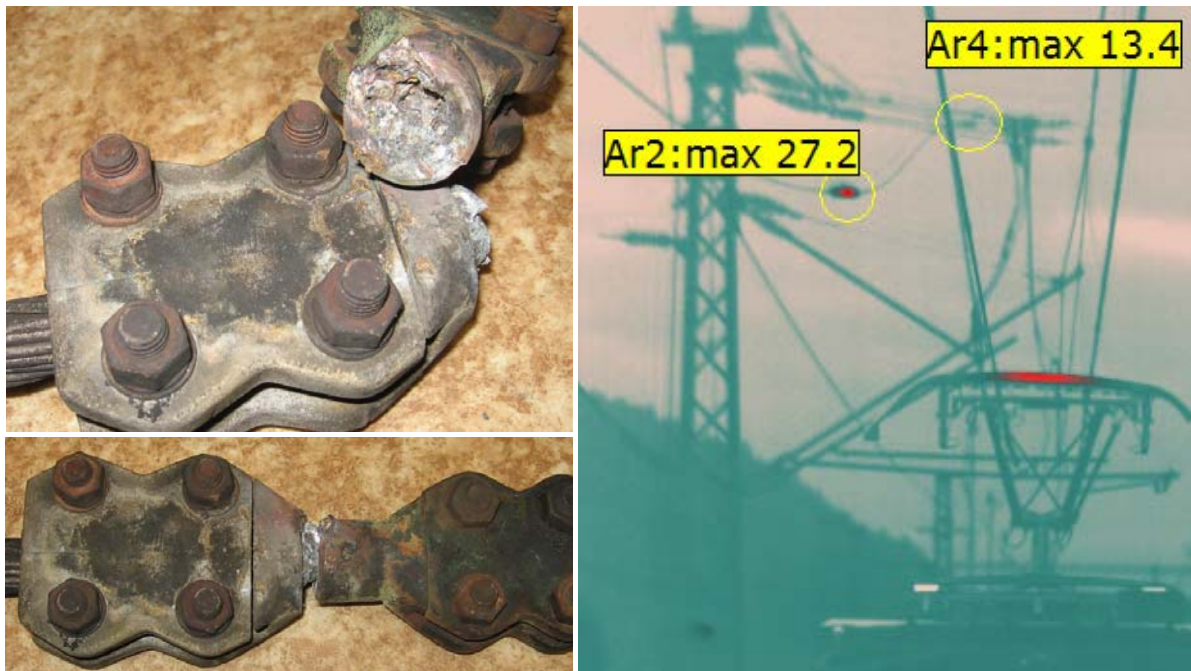
Obr. 8.1: rozpadlá svorka proudového propojení
