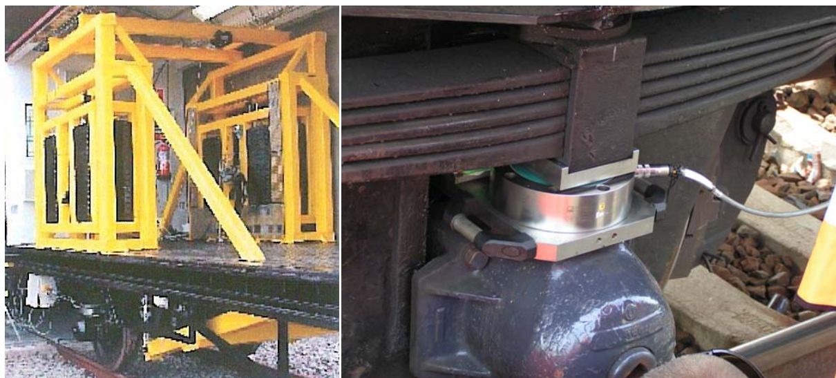
Obr. 5 – RSMV - Pohled na dynamické zatěžovací vybavení a detail snímače osazeného do pracovní polohy
