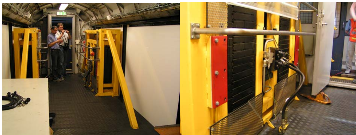
Obr. 6 – Interiér měřicího vozu RSMV se dvěma zařízeními pro vyvolávání dynamických účinků ( oscillating mass) a detail jednoho z nich
