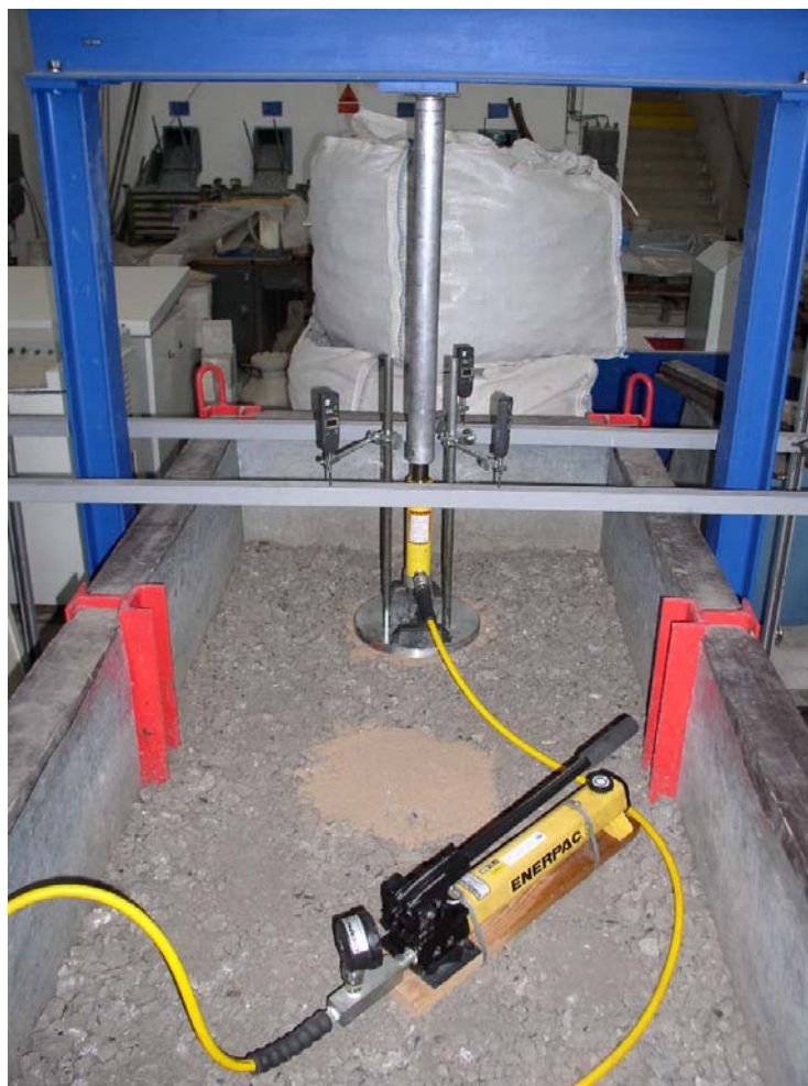
Obr.5 Pohled na měření modulu přetvárnosti na povrchu šterkodrtě v poloze č. 3
