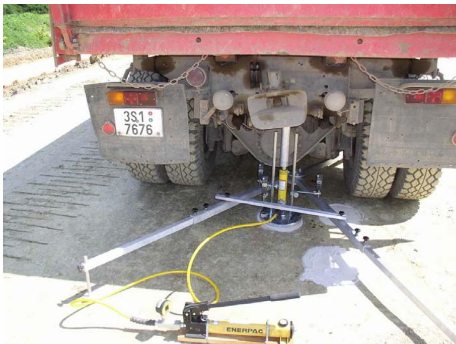
Obr.7 Pohled na měření modulu přetvárnosti na zemině na zkušební poli č. 2
