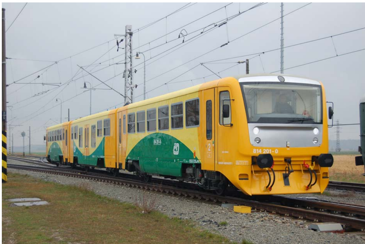
Obr. 3 Motorová jednotka Regionova v třívozovém provedení během zkoušek brzdy na ZC Velim
