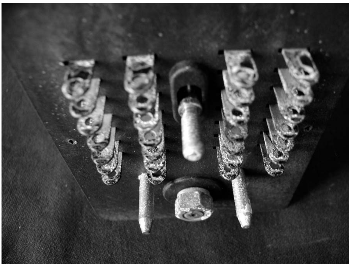
Obr. 4 Relé 8810/02 po expozici v prostředí s SO 2 – pohled na kontaktní pole
