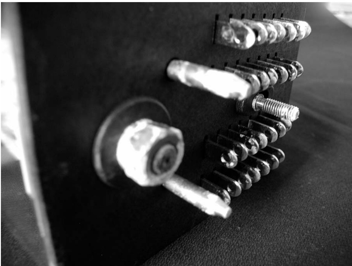
Obr. 1: Relé 8753/02 po expozici v klimatické komoře – pohled na kontaktní pole
