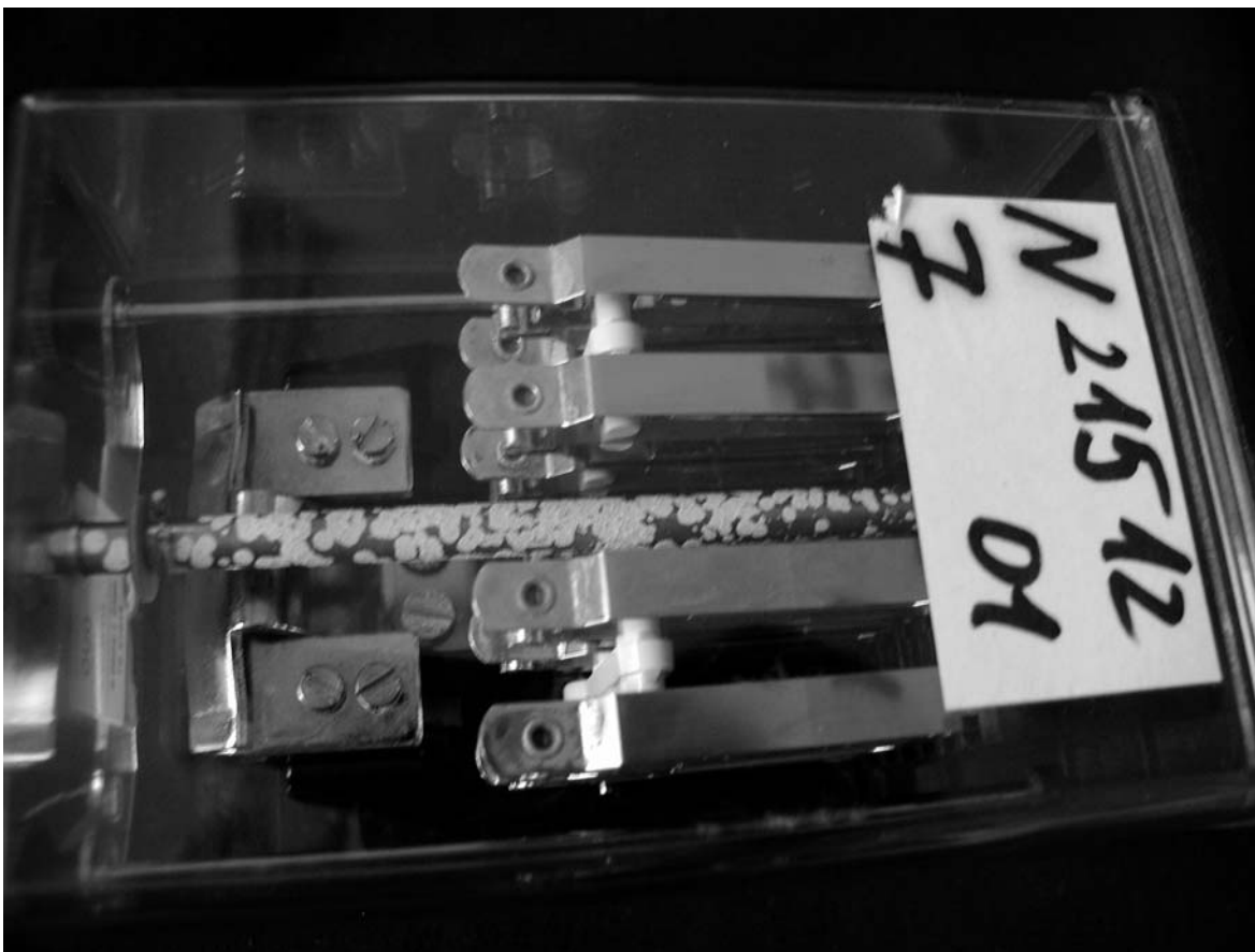
Obr. 3: Relé 21512/01 po expozici v klimatické komoře – pohled na kontaktní ústrojí a svorník
