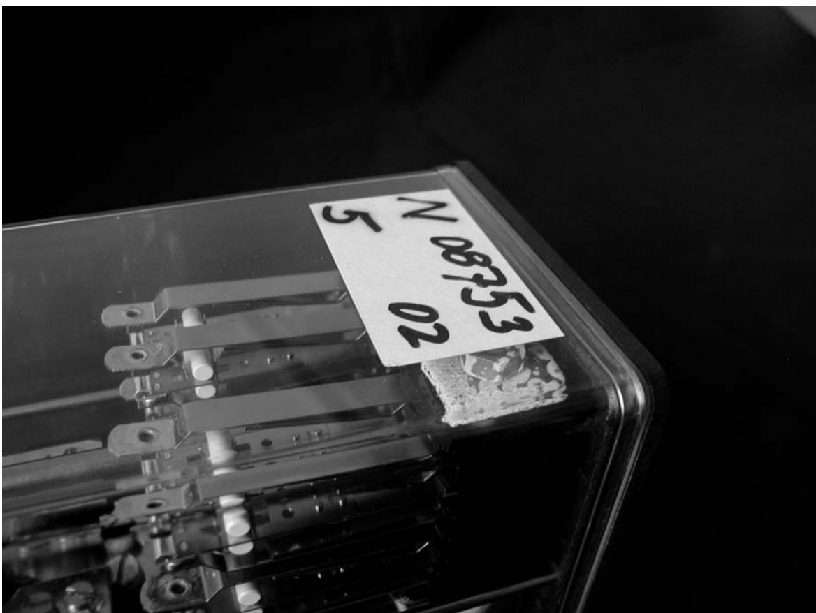
Obr. 2: Relé 8753/02 po expozici v klimatické komoře – pohled na horní část kontaktního ústrojí
