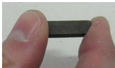
Obr. 2. Segment permanentního magnetu NdFeB pro trakční PMSM
