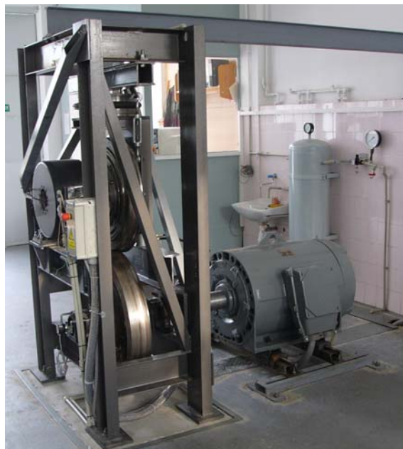
Obr. 8. Experimentální pracoviště s trakčním pohonem s PMSM na Univerzitě Pardubice
