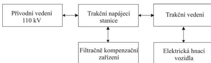
Obr.1 Trakční obvod AC 25 kV, 50 Hz
