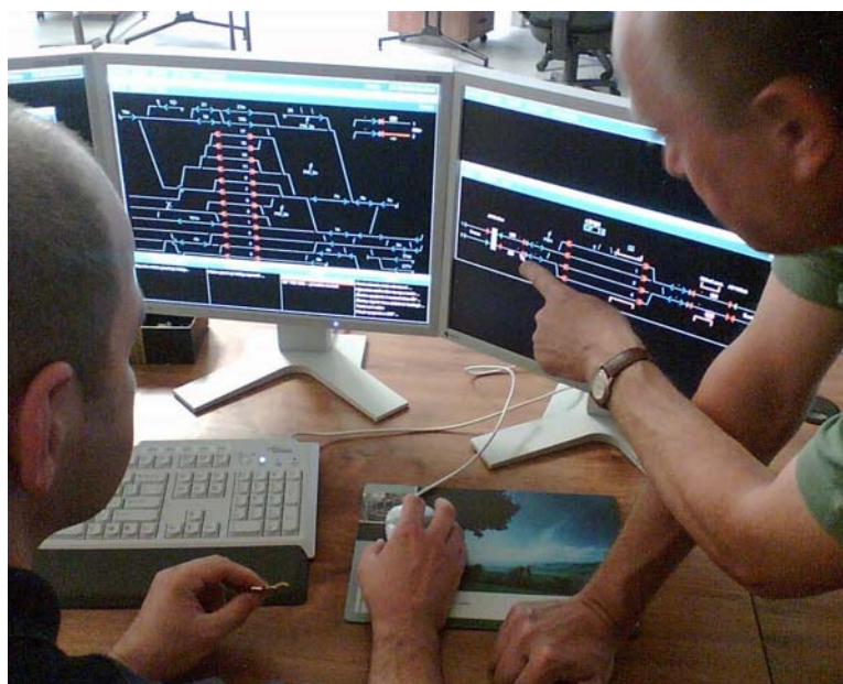
Obrázek 4: Integrované řídicí pracoviště: propojení informačních systémů provozního řízení a zařízení DOZ (Siemens, ILTIS)
