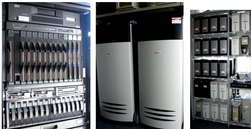
Obrázek 5: Serverová farma pro provozování klíčových informačních systémů, zleva: IBM Blade Center, záložní napájení (UPS), podsít' provozu nekritických aplikací
