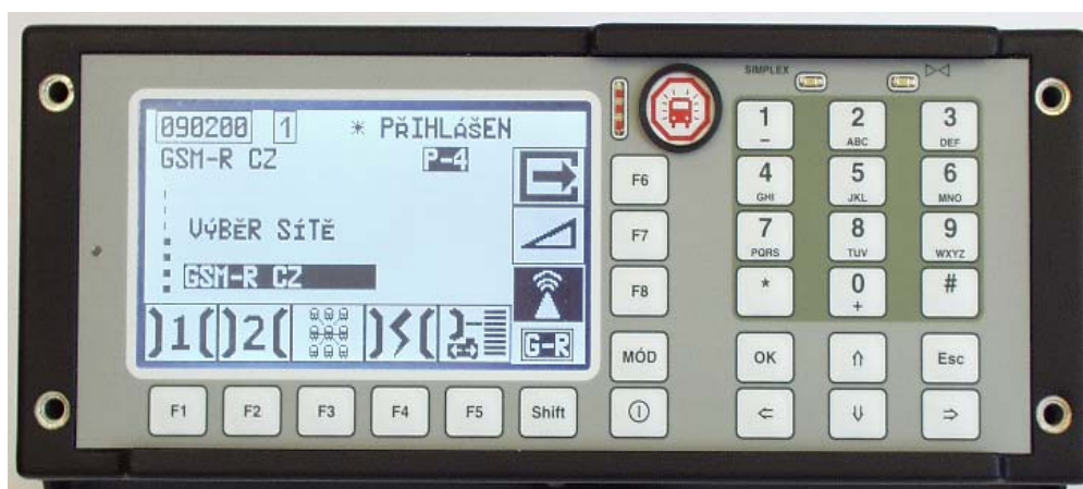
Obr. 2: Příklad grafického zobrazení na mobilním terminálu FXM20
