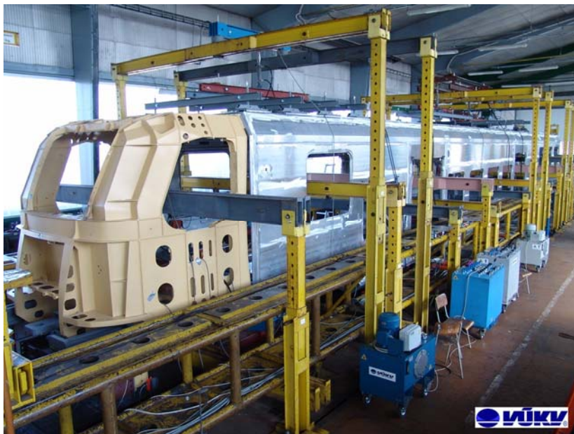
Obr. 8 - Pevnostní zkoušky hrubé stavby hlavového vozu
