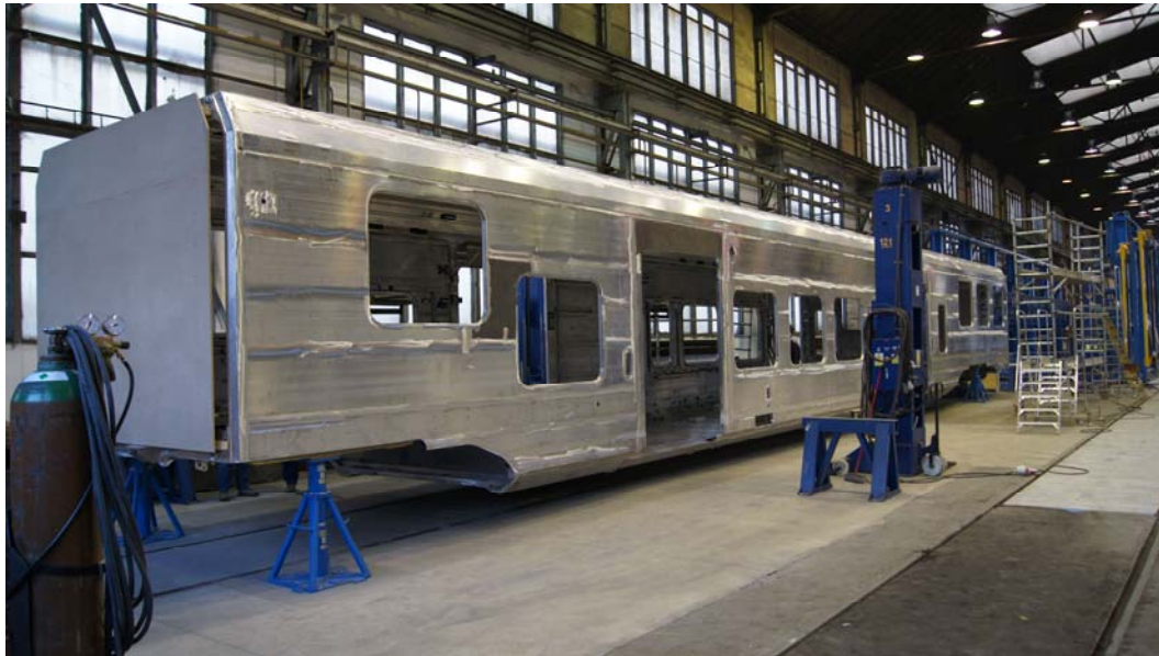
Obr. 7 - Hliníkový tubus hrubé stavby
