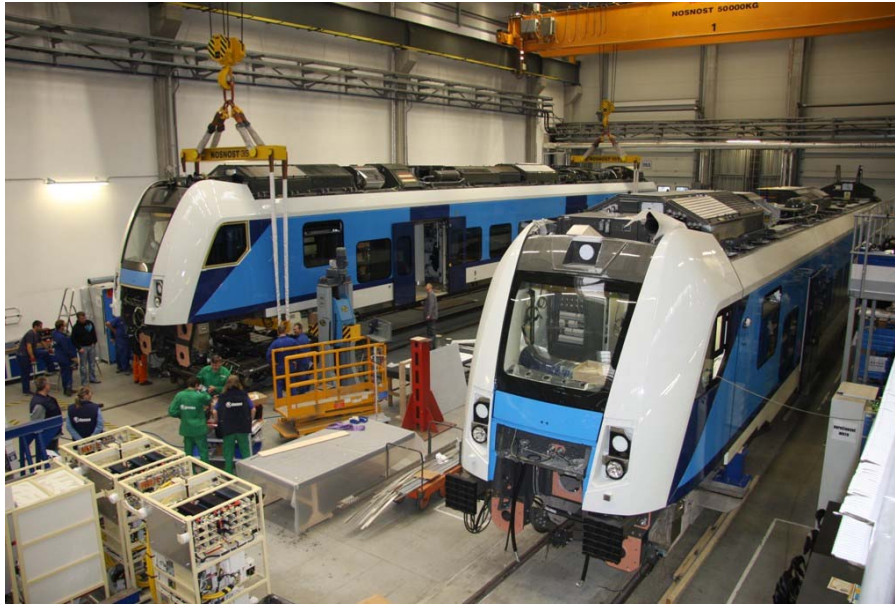
Obr. 13 - Montáž první prototypové dvouvozové dvousystémové jednotky
