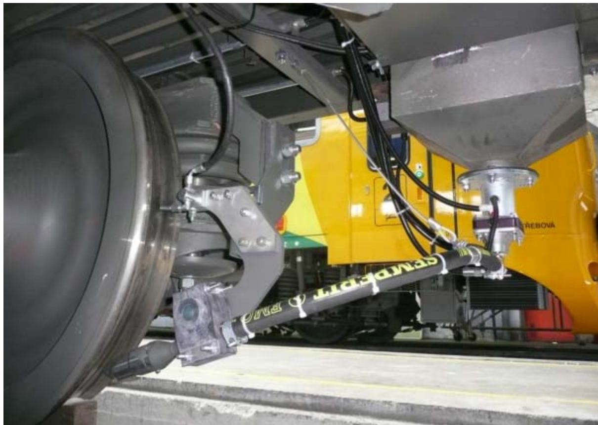
Obr. č. 5 – Provedení mazání a pískování na čelní nápravě m.v. 842
