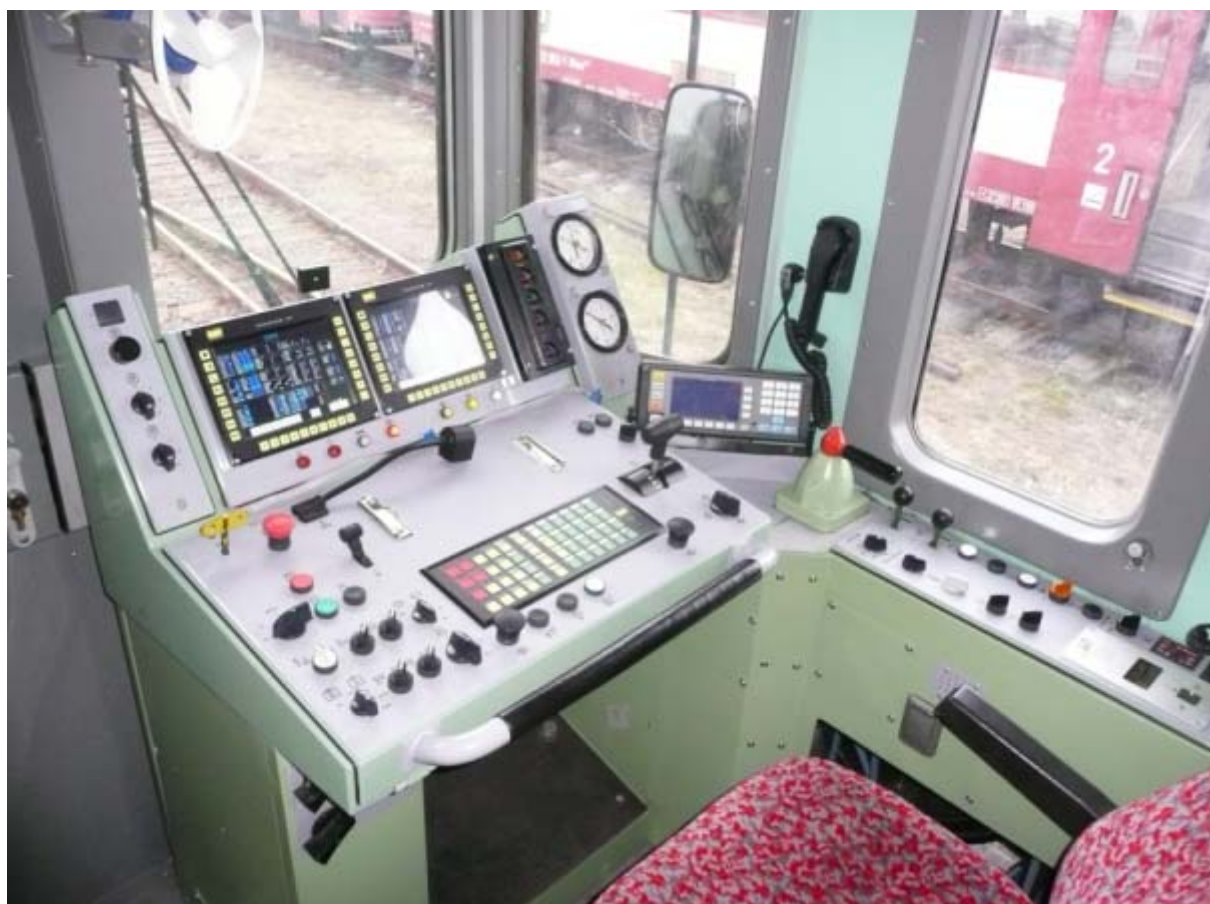
Obr. č. 8 – Pracoviště strojvedoucího m.v. 842 po modernizaci
