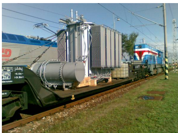
Obr. 3 Přeprava nového regulačního transformátoru
