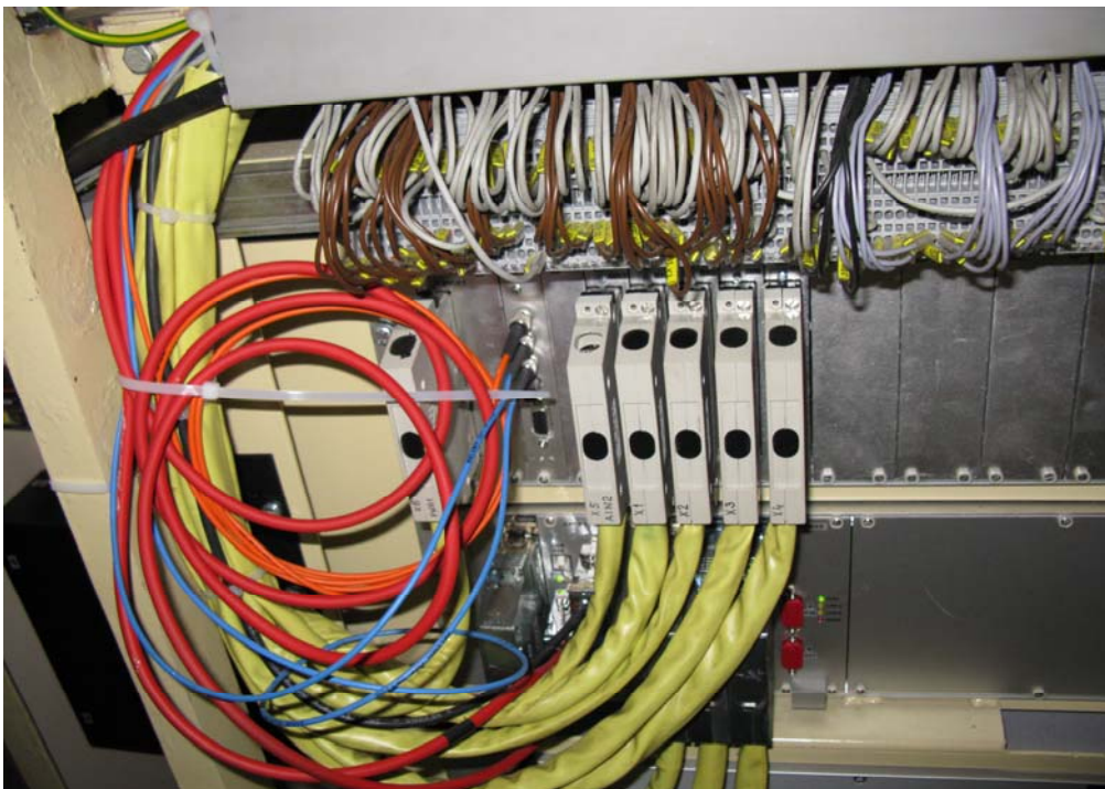
Obr. č. 2 Pohled na zástavbu elektroniky řídicího systému a elektronického rychloměru
