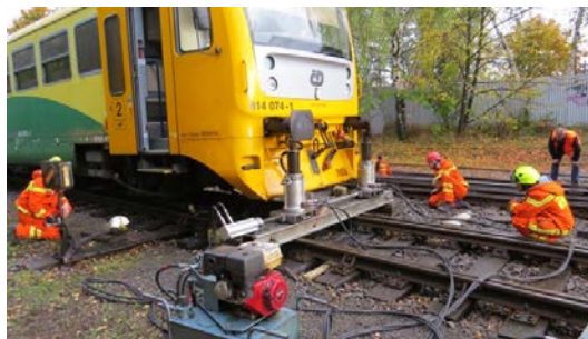
Obrázek č. 11 – Nakolejování pomocí sady Hoesch
