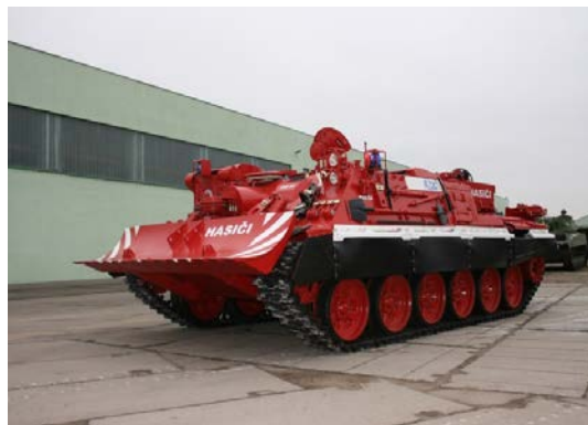
Obrázek č. 6 - Vyprošťovací tank VT- 72 B
