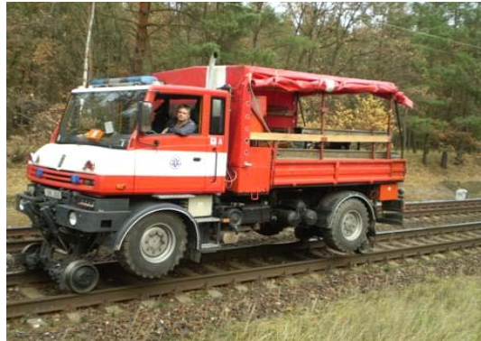
Obrázek č. 5 - Dvoucestné vozidlo TA PRAGA M2
