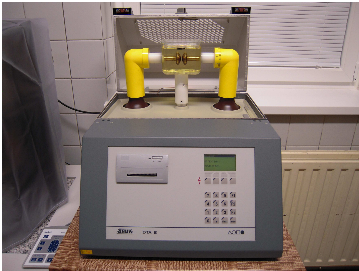
Obrázek 2: Automatická zkušební komora průrazného napětí izolačních olejů BAUR DTA 100 EE
