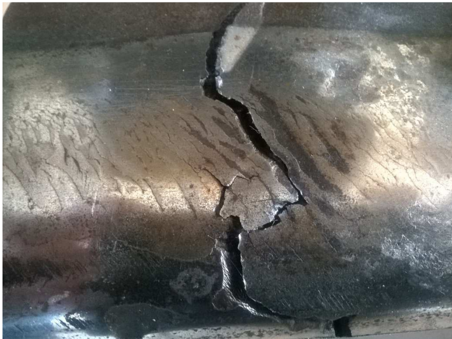
Obr. 1 - Vzorek kolejnice z mimořádné události v anglickém Hatfieldu
